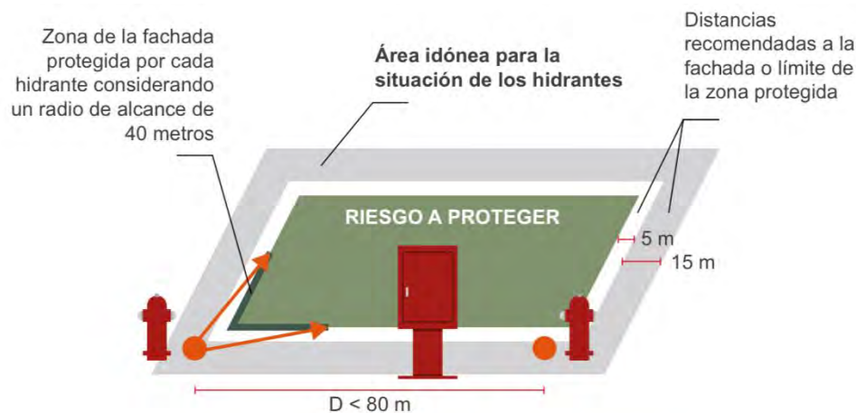
Criterios de distribución de los hidrantes exteriores
